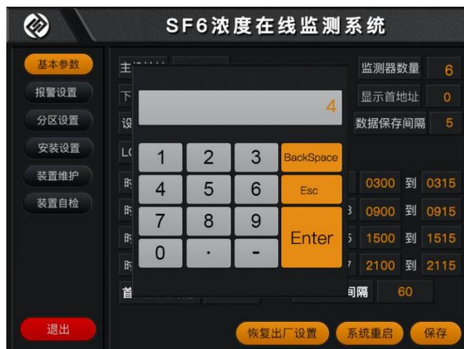
在键盘上输入设定的地址编码，比如 4，后点击【Enter】，即可完成主机地址的参数修改。
