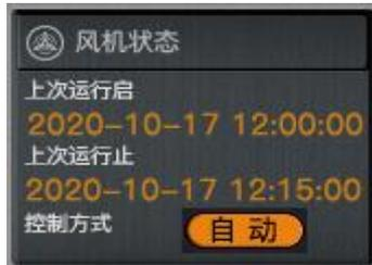
主要显示风机上一次的运行启动时间、上一次的运行停止时间以及风机当前的控制模式，控制模式可选为【自动模式】和【手动模式】，如图中所示含义为，风机控制模式：【自动模式】
