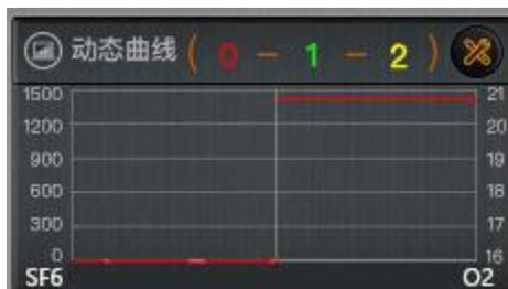
显示当前选定的 O2/SF6 监测单元测量的实时 O2 含量、SF6 含量动态曲线,该曲线可设置对应 3 只监测单元,分别丢应红、绿、黄色彩显示,3 只监测单元轮流显示,如图所示,当前显示的红色曲线对一个的是 0 号 O2/SF6 监测单元,测量值分别为 O2:20.75% SF6:0000PPM
