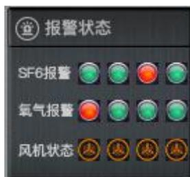
报警状态由 SF6 报警状态、O2 报警主管台、风机运行状态构成,报警指示灯按照分区进行排列,以列为单位,分别对应 0 分区、1 分区、2 分区、3 分区各自的报警状态,当对应分区报警后,对应分区的指示灯变为红色闪烁,如上图所示,同时对应分区的风机启动。
